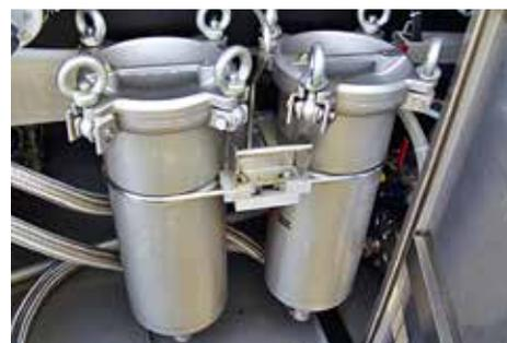
Sistema di filtraggio bidirezionale per la massima efficienza.
