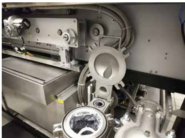
Componenti della macchina in acciaio inossidabile con sistema di filtraggio accessibile
