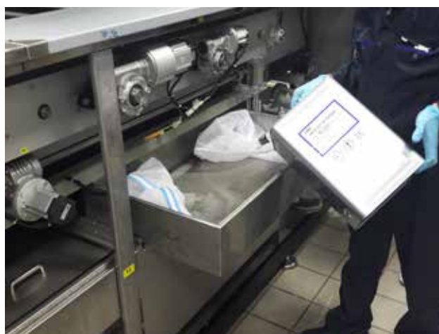
Contenitore soluzione di lavaggio concepito per facilitare l'accesso dell'operatore
