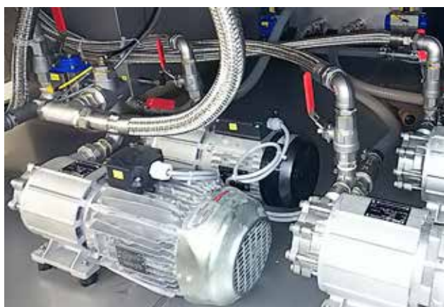
Pompe magnetiche in acciaio inossidabile per una semplice manutenzione. Questo tipo di pompa non presenta una guarnizione, il che significa che non vi sono problemi di perdite d'acqua
